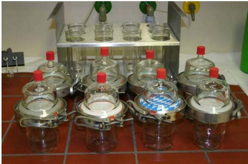
**Abbildung 6-4: Migrationszellen befüllt mit Lebensmittelsimulanz Ethanol 95%.**
