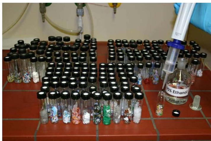
**Abbildung 6-3: Bestimmung der Migrantenkonzentration in der Verpackung mittels Extraktion.**
